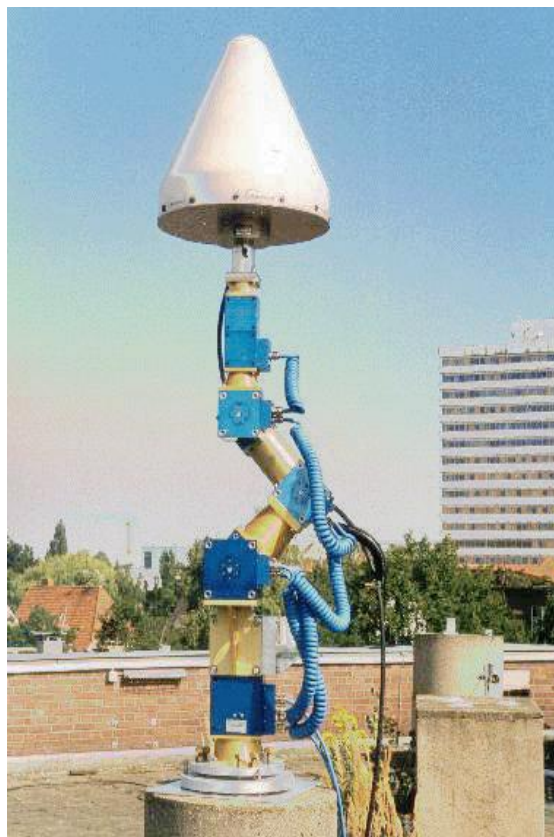
Рис. 5.21. Установка для абсолютной калибровки антенн в реальном времени ( http://www.geopp.com/gnpcvdb/AOA_DM_T/ )
