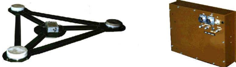
Рис. 4.22. Приемник МРК-11 с тремя антеннами для определения координат, скорости и ориентировки объекта в пространстве ( http://www.ire.krgtu.ru/struct/lab/niirt/new_page_1.htm )
