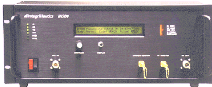
Рис. 4.24. Псевдоспутник IN500 фирмы IntegriNautics ( www.integrinautics.com/technology/pseudolites.html )
