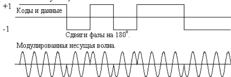
Рис. 4.12. Бинарная парафазная модуляция несущей частоты
