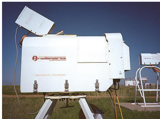
Рис. 6.10. Микроволновый радиометр паров воды корпорации Radiometrics ( http://radiometrics.com )
