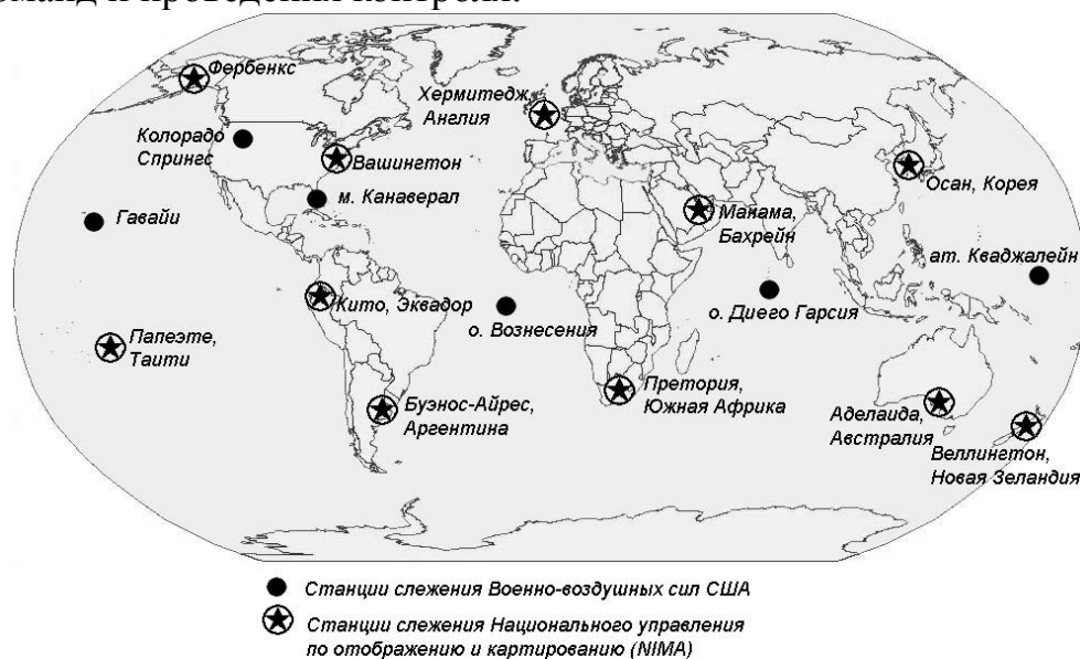
Рис. 4.6. Расположение станций контрольного сегмента GPS
