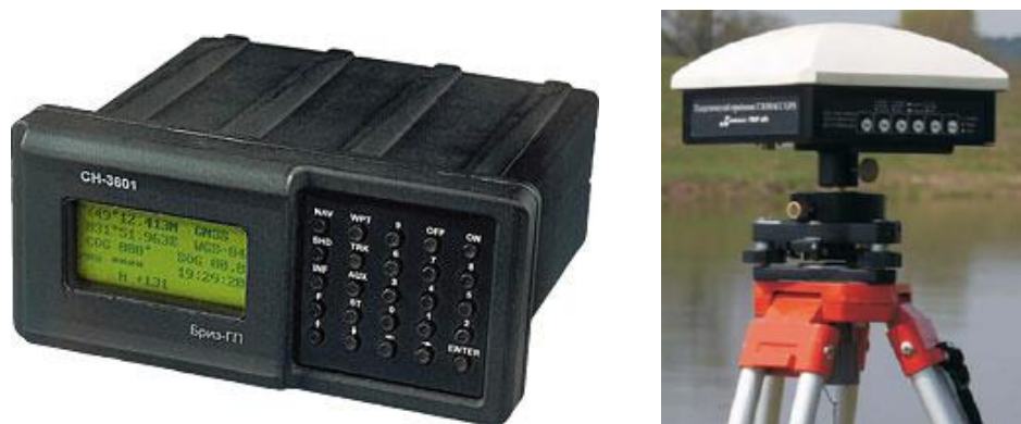
Рис. 5.20. Российские геодезические приемники CH-3601 КБ «НАВИС» (слева) и ГЕО-161 ОАО РИРВ
