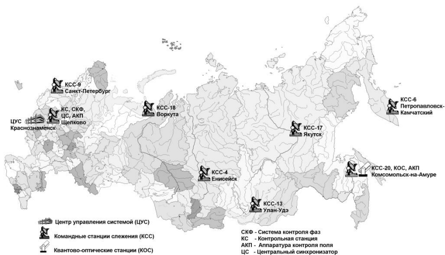
Рис. 4.19. Наземный комплекс управления ГЛОНАСС
