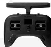
**TBS. TBS Crossfire** – дальнбойная система, работающая на частоте 900 МГц. Бывают как внешние передатчики (JR-модуль), так и внутренние (Например, встроен в аппаратуру TBS Tango 2).
