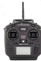
**ELRS. ELRS (он же ExpressLRS - Express Long Range System)** – система с открытым исходным кодом, которую поддерживает всё сообщество. Есть версия на 900 МГц и 2,4 ГГц. Бывают, как внешние передатчики (устанавливаются во внешний JR модуль на аппаратуре), так и внутренние. Работает на протоколе CRSF (Crossfire).
