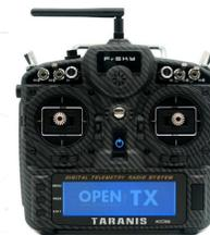
**FrSky. OpenTX.** Для использования ExpressLRS требуется версия OpenTX, не менее OpenTX 2.3.12. Так же сборка OpenTX должна включать параметры CRSFshot, а так же поддержку lua скриптов. Новая версия необходима для поддержки технологии crsfshot (Mixersync), которая обеспечивает правильную работу протокола и низкую задержку. По возможности используйте последнюю версию прошивки.
