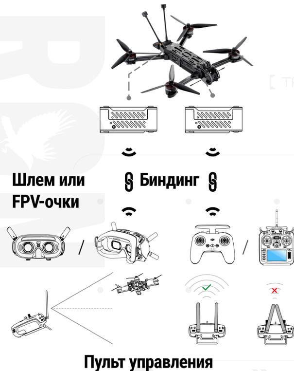
**Биндинг (англ. Binding)** – процесс установки постоянной связи (привязки приемника к передатчику). После этого приемник воспринимает команды только от этого передатчика, игнорируя все остальные. Это одна из причин, почему на частоте 2,4 ГГц одновременно могут работать множество передатчиков. Подразумевается, что вы используете совместимые приёмники и передатчики.
