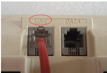
Рис. 2 Гнездо для подключения кабеля на телефоне
