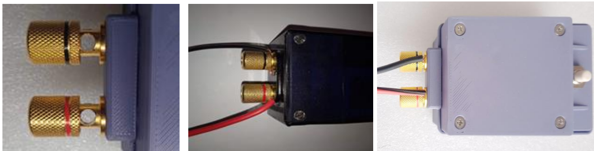
Рис. 3 Клеммы для подключения полевой линии
