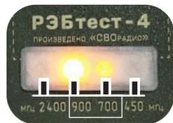
⑤ Мощность излучения лучше всего оценивать по точке полного погасания светодиода, медленно удаляя детектор от источника излучения до момента, пока глаз перестает различать свечение. Полученные замеры расстояния можно использовать для сравнения антенн и передатчиков.
